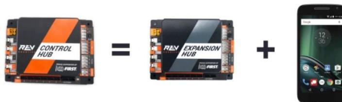
Le Concentrateur de commande, ayant le périphérique Android intégré connecté directement au Concentrateur d'extension à l'aide d'un bus série interne, élimine le besoin d'une connexion USB externe entre le Contrôleur du robot Android et le module d'E/S.
