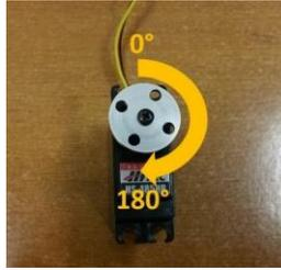
Un servomoteur typique peut tourner et maintenir une position de 0 à 180 degrés.
