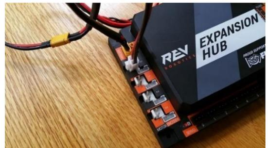
**4.3 Connexion d'un servo au Concentrateur**
