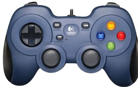
Les boutons colorés sur le côté droit de la manette de jeu seront utilisés pour contrôler la position du servo.
