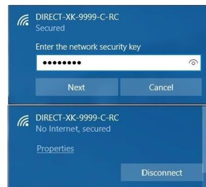
Si l'affichage n'est pas mis à jour, comme indiqué, après quelques secondes, essayez de cliquer sur Connexions réseau/Network Connections en bas de la case bleue affichant les connexions Wi-Fi. Cela fera apparaître une boîte de dialogue Paramètres qui comprend un lien vers «Afficher les réseaux disponibles», qui peut être utilisé pour forcer la mise à jour de la liste des connexions Wi-Fi.
