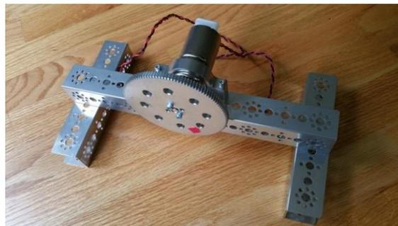
*Banc d'essai de moteur fabriqué à partir de composants de construction Tetrax.*
