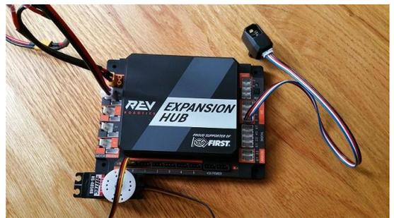
**4.5 Connexion d'un capteur tactile au Concentrateur**
